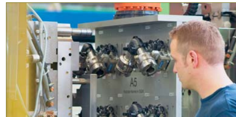
o.l.: Olivier Carnal, Ph.D., Head of Technology Development o.r.: Absperrklappe für Wassertransport in Industrie- und Versorgungsanwendungen unten: Spritzgossen mit Mehrfachformen in der Fitting Produktion
